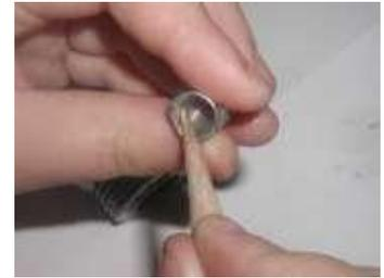
Une fois sur deux ça coince ! Il ne faut pas se précipiter sur le marteau et le chasse-goupille et traiter ce problème à la barbare. Il suffit de prendre une lame de scalpel n°11 et de retirer la petite bavure qui s'est formée par matage au niveau de la gorge du circlips. Une loupe vous permettra de voir cette bavure et de l'ôter sans coup férir. Une légère poussée et notre
