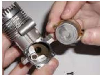
Le démontage de la bougie se fait à ce moment, il sera plus dur de le faire une fois la culasse démontée. Passons maintenant à la tête de culasse. Quatre ou six vis sont à démonter avec le tournevis adéquat. Un coup d'œil dans le cylindre est utile pour voir si des corps étrangers n'y ont pas pénétré. Si oui, il faut les retirer, ce que je fais avec un cure-dent en bois ou un morceau de balsa taillé en pointe.
