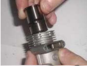
Arrive maintenant le démontage de l'axe de bielle. Retirons tout d'abord le ou les clips avec une pince à becs fins et ne les perdons pas bêtement. Il suffit de pousser maintenant sur l'axe de piston pour le faire glisser avec un jonc d'aluminium ou de bois d'un diamètre un tantinet inférieur au diamètre de l'axe.
